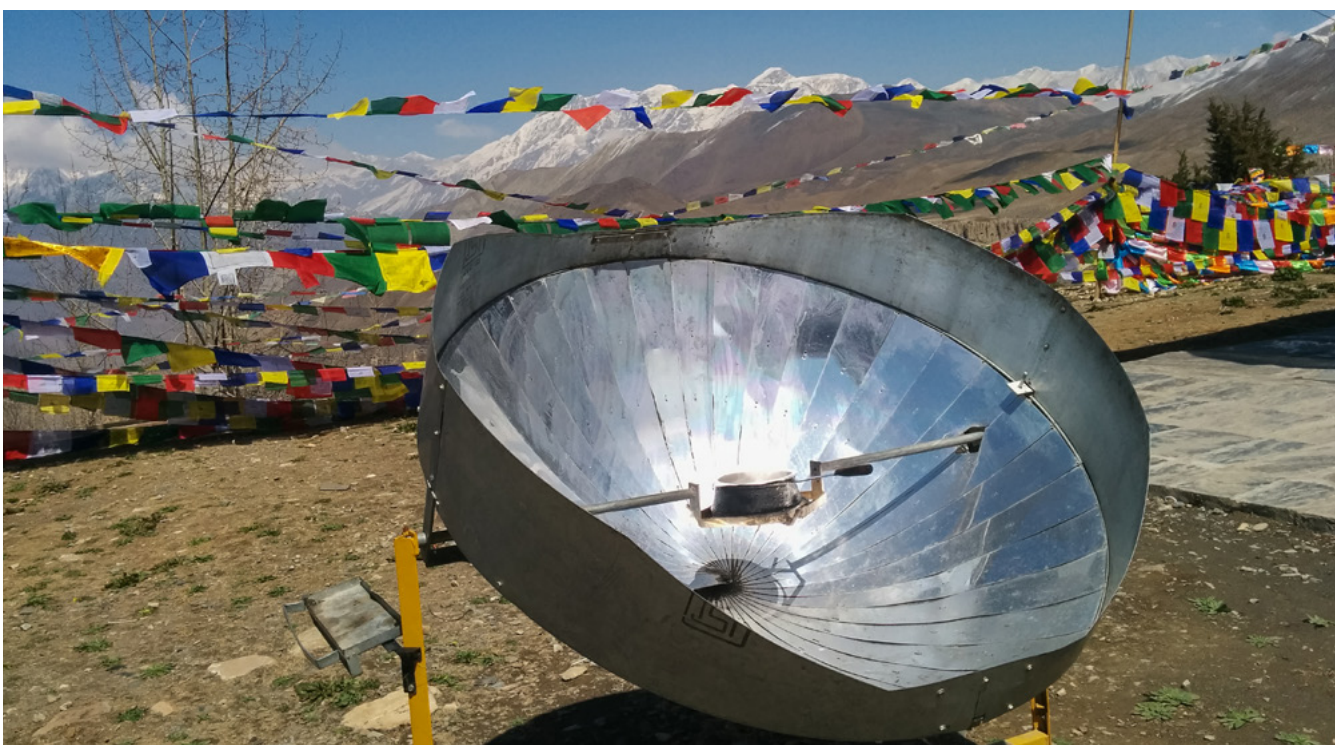
Capteur solaire parabolique pour le chauffage de l'eau au Népal. (Photo : Taras Shchetinin/Shutterstock)
